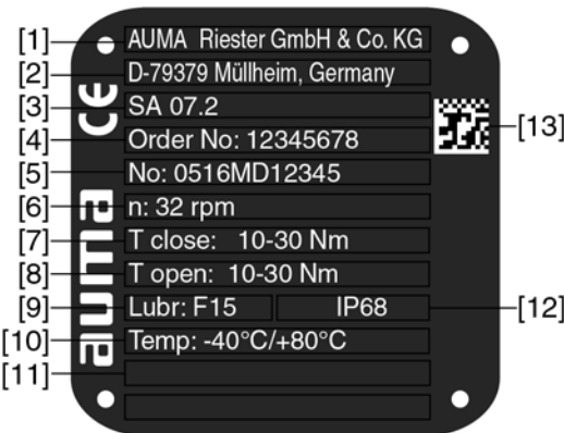
Rysunek 2: Tabliczka znamionowa napędu ustawczego (przykład)
