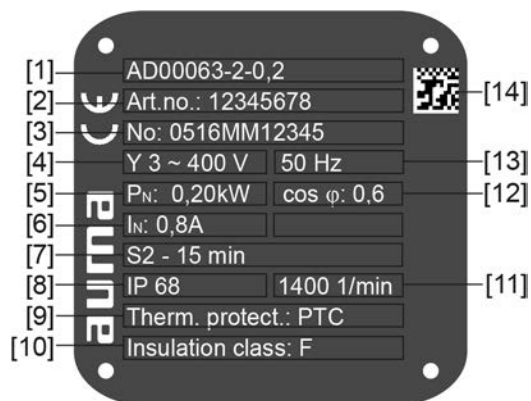
Rysunek 3: Tabliczka znamionowa silnika (przykład)
