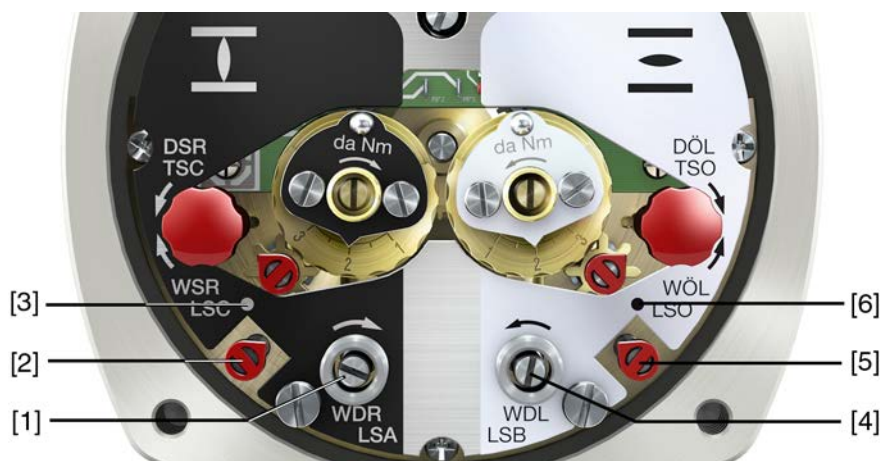
Rysunek 35: Elementy nastawcze wyłącznika krańcowego
